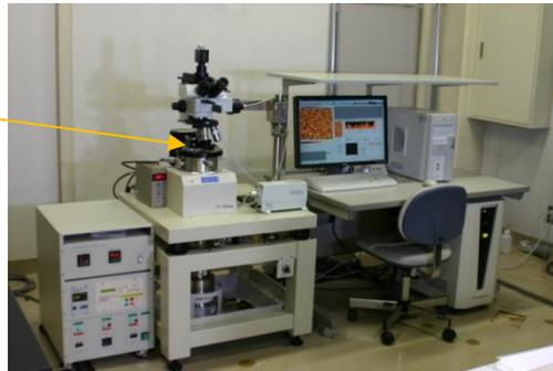
図2 装置：日立ハイテクノロジーズ製 AFM5300E
