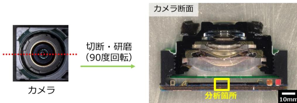
【図1】スマートフォンカメラの断面観察(デジタルマイクロスコープ(DMS)像)
