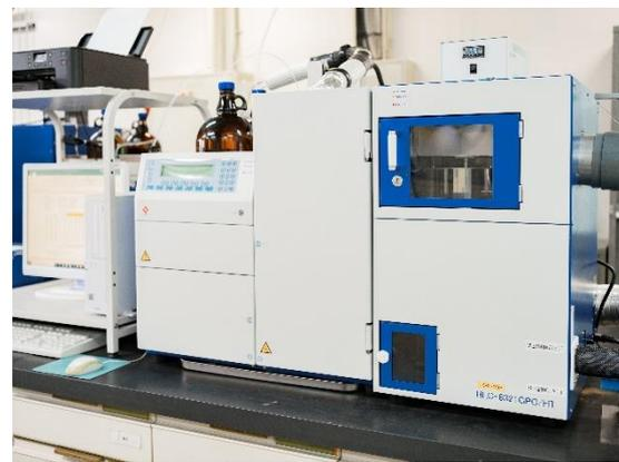
【図 2】 高温 GPC 装置外観 (超高温 GPC にも対応)
