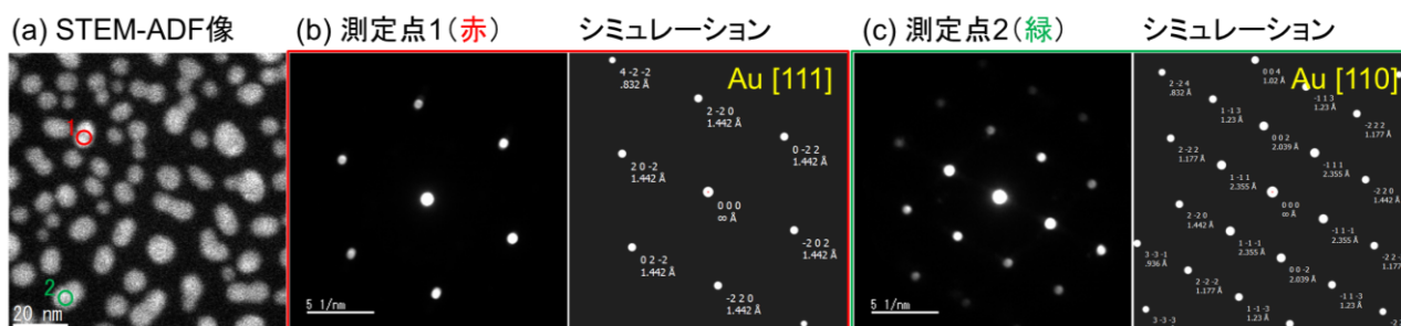
【図 2】 Au ナノ粒子のナノビーム電子回折マップによる結晶方位解析
